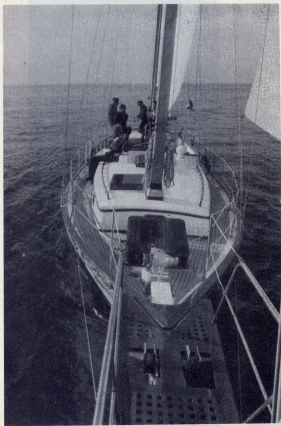
La larghezza di tre metri e sessantacinque centimetri risulta leggermente «costretta» in questa foto scattata con un 28 millimetri. La ritengo comunque necessaria per dare l'idea dell'eleganza d'insieme di questa barca. La tuga è di sandwich di fibra di vetro e balsa.
